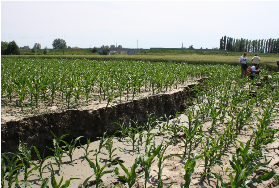
Fig. 5 – Ampia fenditura del terreno con rigetto di 1,5 m dalla quale è uscita una gran quantità di sabbia liquefatta presso San Carlo (FE)
