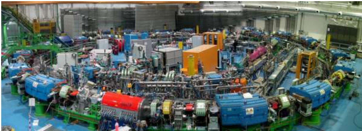
Figura 7 Panoramica del sincrotrone. Si vedono i magneti deflettori (blu) e la cavità a radiofrequenza (rossa) che accelera le particelle che circolano nell'anello per un milione di giri in circa un secondo. (Per gentile concessione della Fondazione CNAO)
