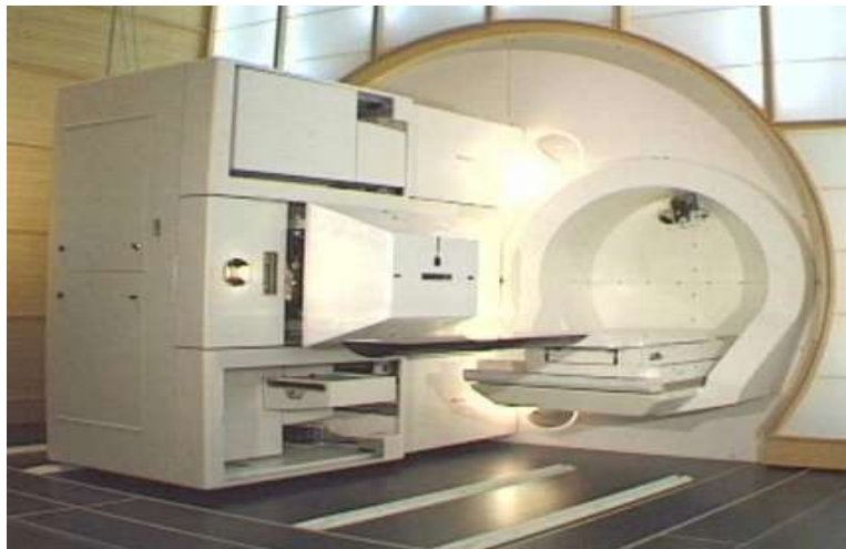
Figura 4 La testata rotante del PSI (Villigen, Svizzera) contiene il primo esempio di un nuovo sistema 'attivo' di distribuzione della dose.
