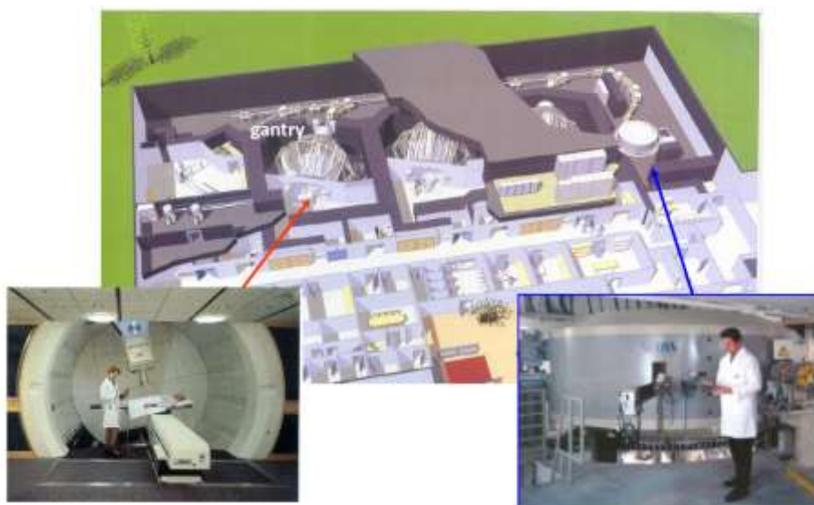
Figura 2 Un centro tipico della ditta belga IBA è dotata di tre sale con testate isocentriche, cioè strutture di 10 metri di diametro che fanno ruotare grandi magneti e permettono di inviare il fascio di protoni sul paziente secondo la direzione scelta del radiooncologo.
